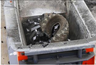
Durch die Kraft der asynchron laufenden Paddelwellen werden selbst schwerwiegendste Altreifen zerkleinert
